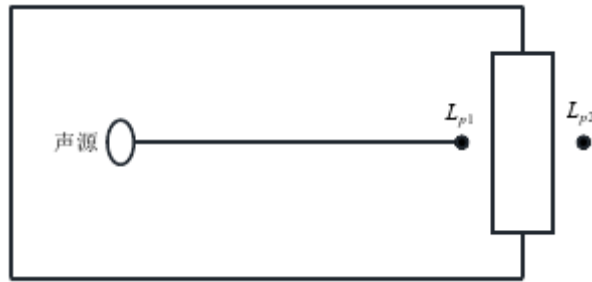
图1. 室内声源等效为室外声源图例
