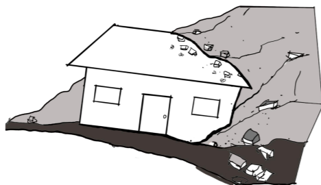
邻近边坡土体失稳
