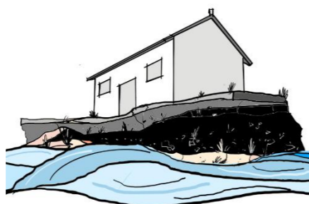
水流冲刷掏空地基
