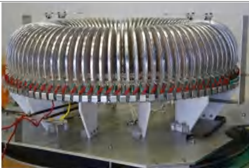
图 9.2 高频变压器
