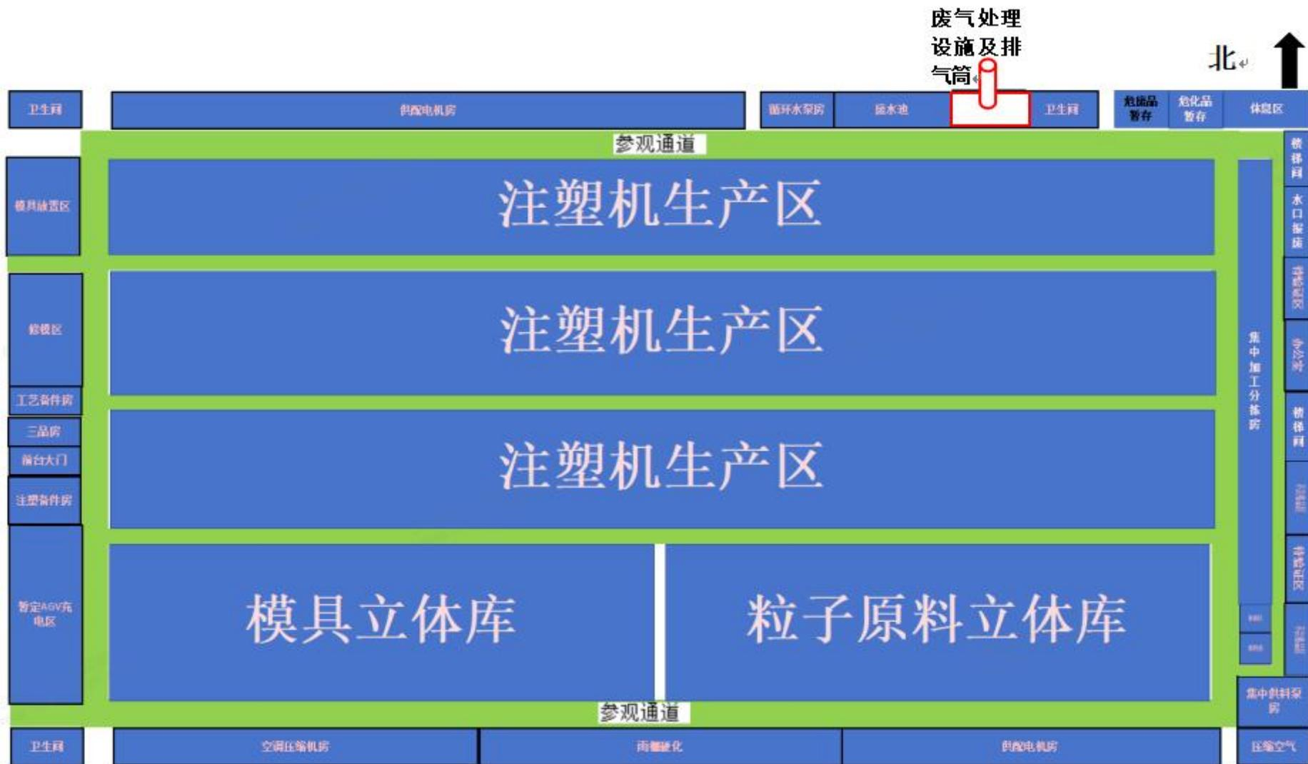
附图 4-4 本项目 7-2#生产厂房平面布置图 比例：1:664.9
