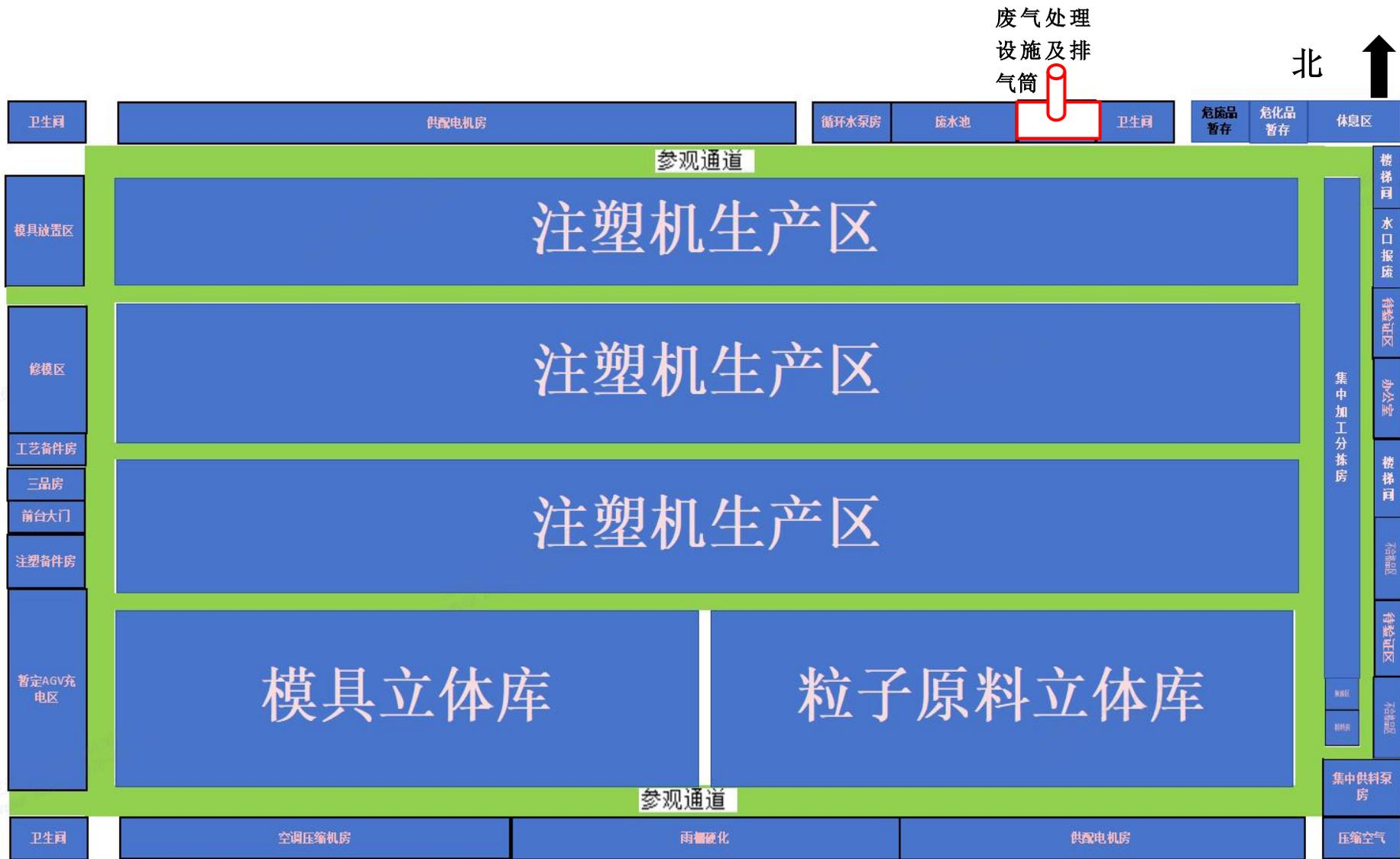
附图 4-2 本项目 6-2#生产厂房平面布置图 比例：1:664.9
