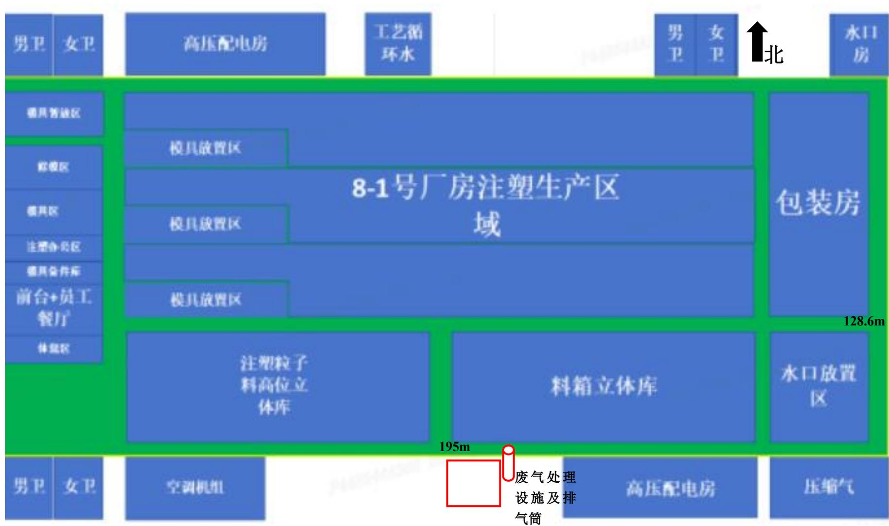
附图 4-5 本项目 8#生产厂房平面布置图 比例：1:866.7
