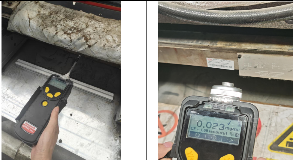
图 4-2 比亚迪汕尾园区护板项目热压模具区域现场实测照片
