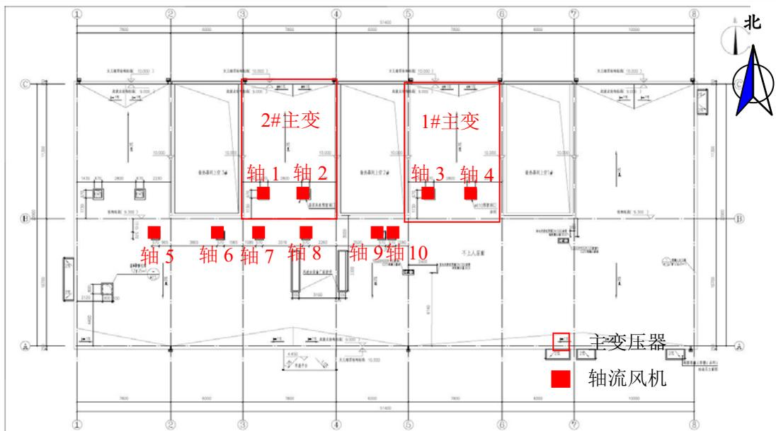
图 4-3 110kV 熙泰变电站声源分布情况示意图（二层屋顶平面图）
