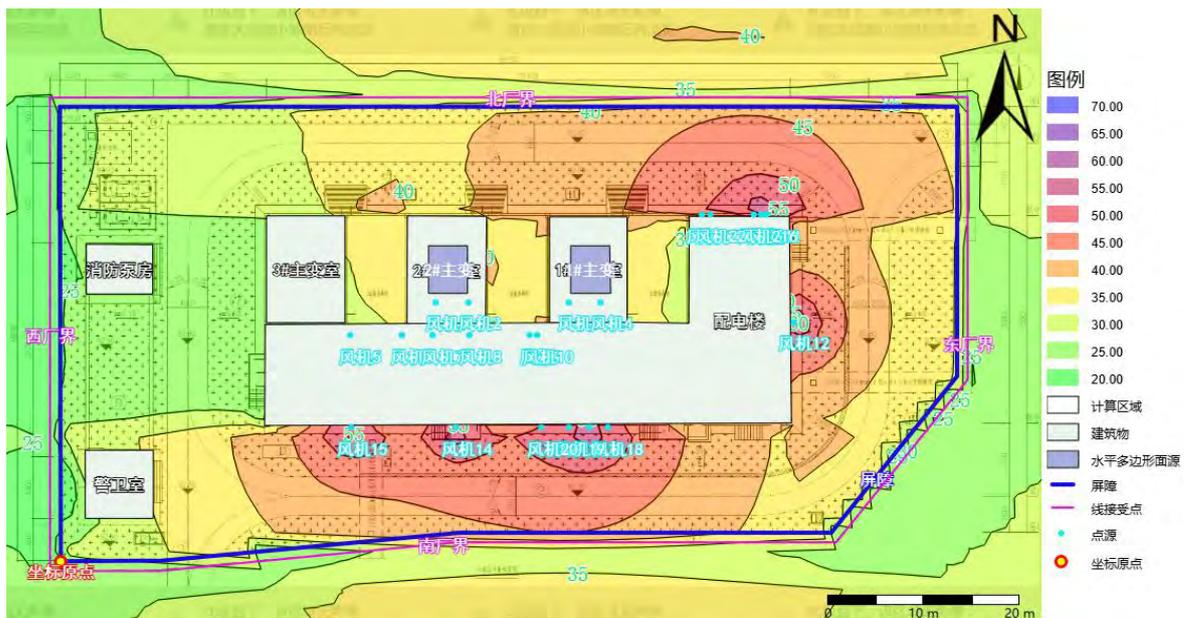
图 4-7 110kV 熙泰变电站厂界噪声预测等值线图（地面 1.2m）
