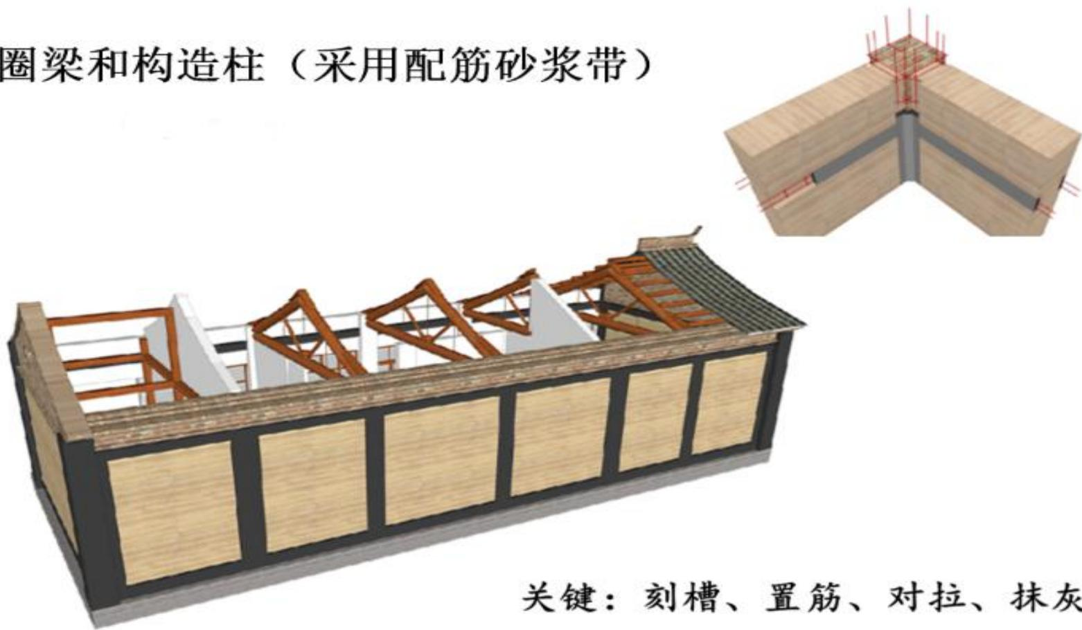
关键：刻槽、置筋、对拉、抹灰
