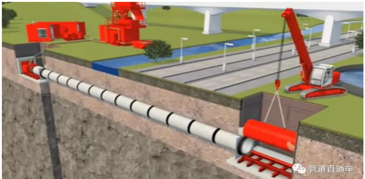
图 2-7 常见顶管施工演示图
