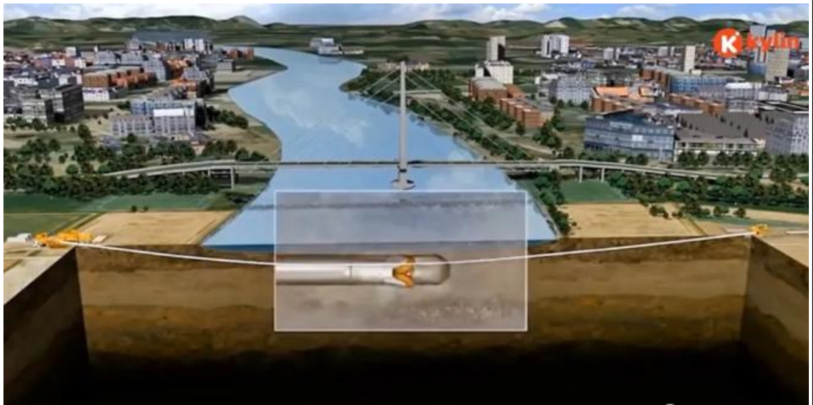
图 2-8 常见拉管施工演示图
