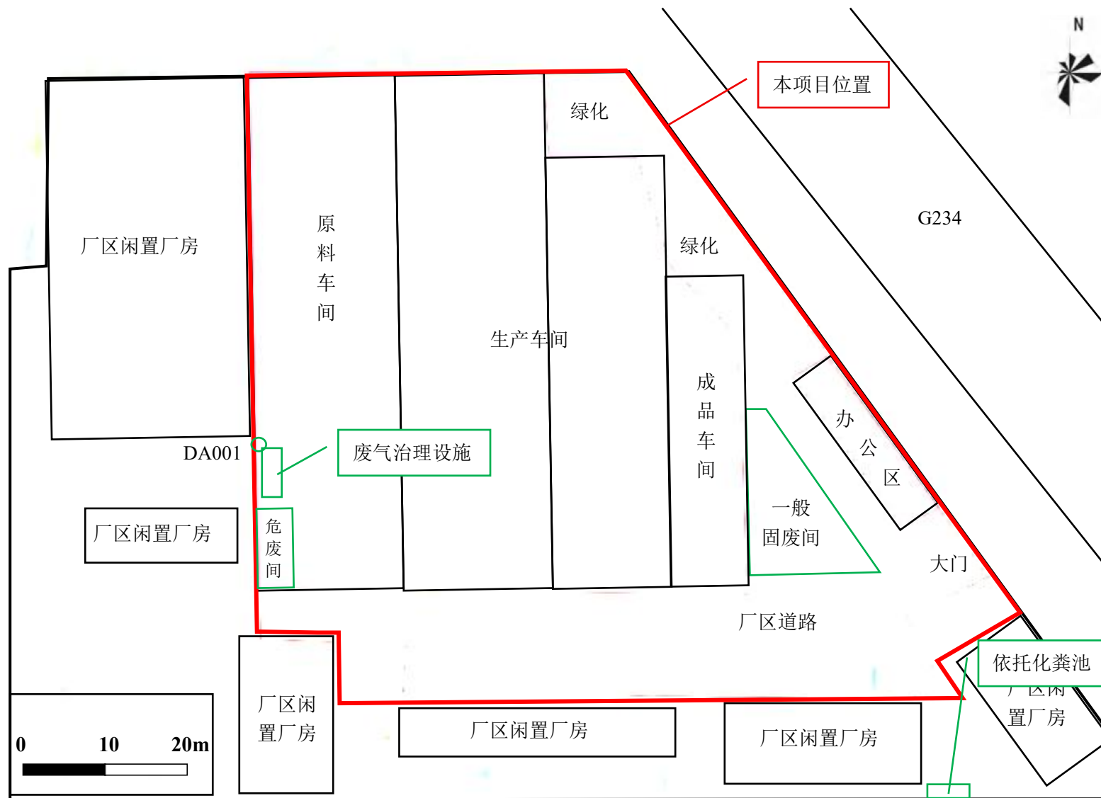
附图五 本项目厂区平面布局示意图
