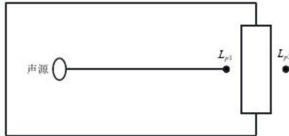
图9 室内声源等效为室外声源图例
