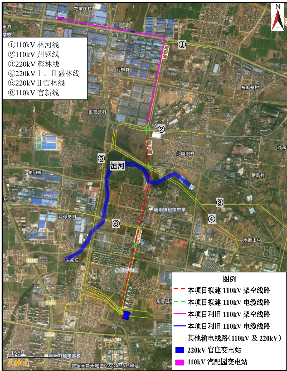
图 2-4 本工程 110kV 输电线路走径示意图
