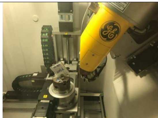
图 9-3 本项目工业 CT 装置内部构造示意图
