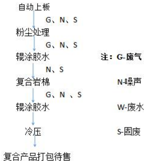
图 9 外墙保温一体板生产工艺流程及产污位置图
