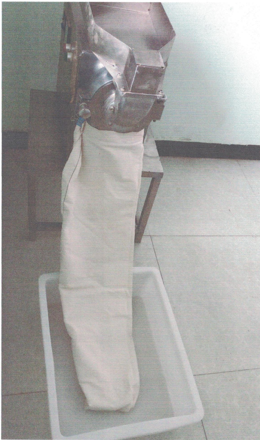
附图 5 配料、粉碎工序袋除尘设备整改图片
