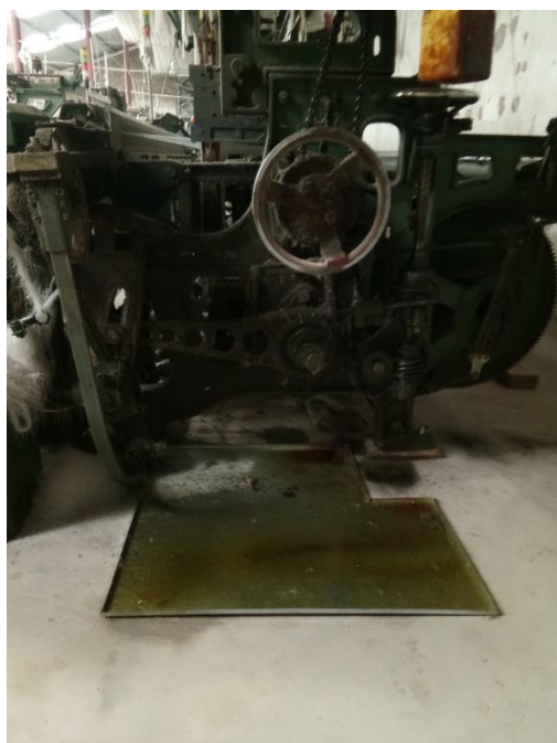
附图 8 机械设备防漏集油托盘整改照片
