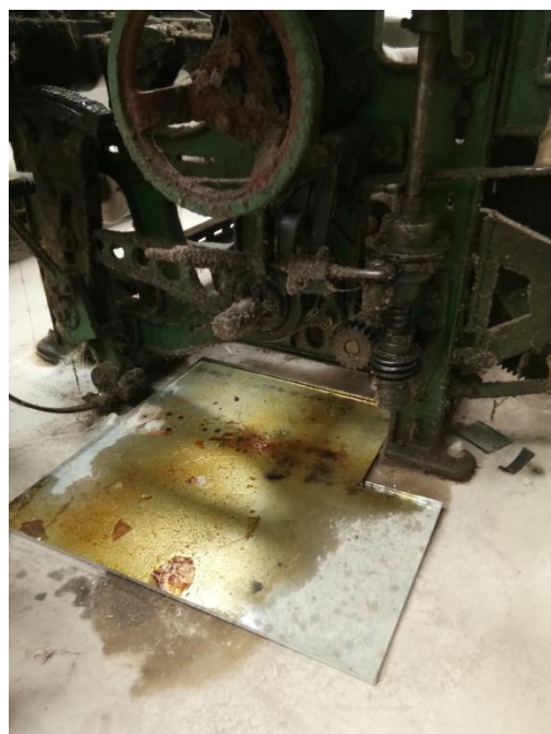
附图 8 机械设备防漏集油托盘整改照片
