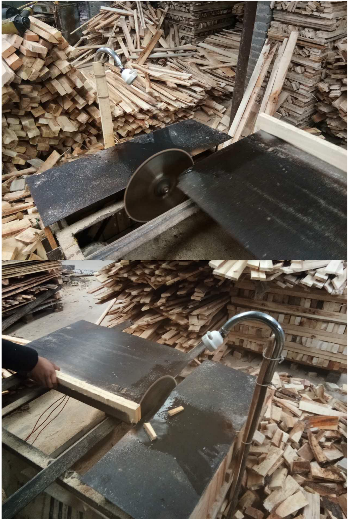
附图 6、湿法作业水喷淋整改照片
