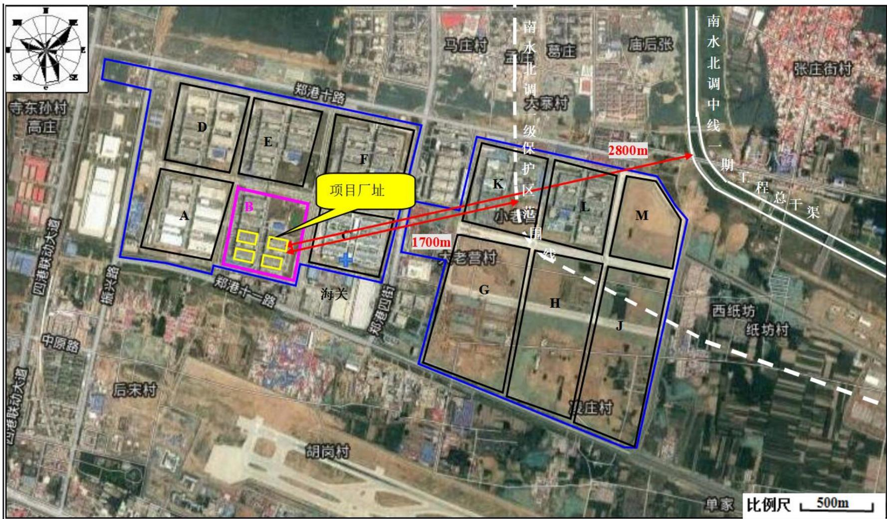
附图 5 本次工程厂址与南水北调中线一期工程总干渠二级保护区位置关系示意图
