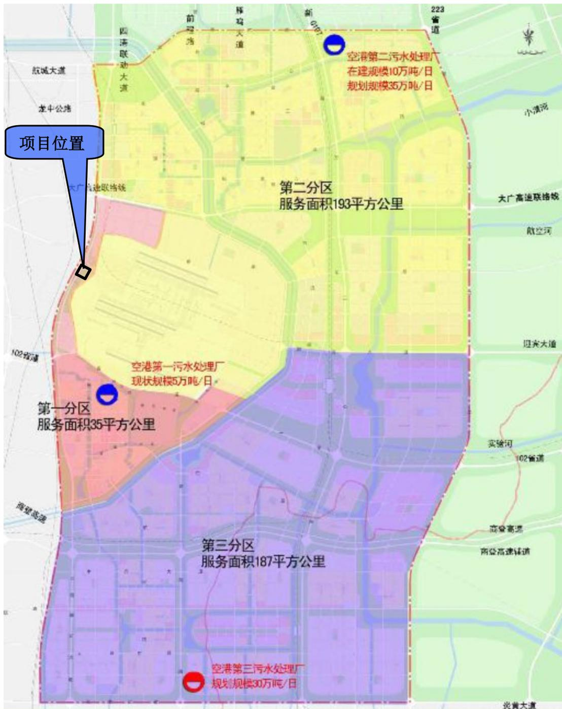
附图 6-2 郑州航空港经济综合实验区污水工程管网规划图
