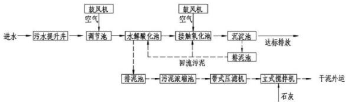
图 7 台湾科技园污水处理站工艺流程图
