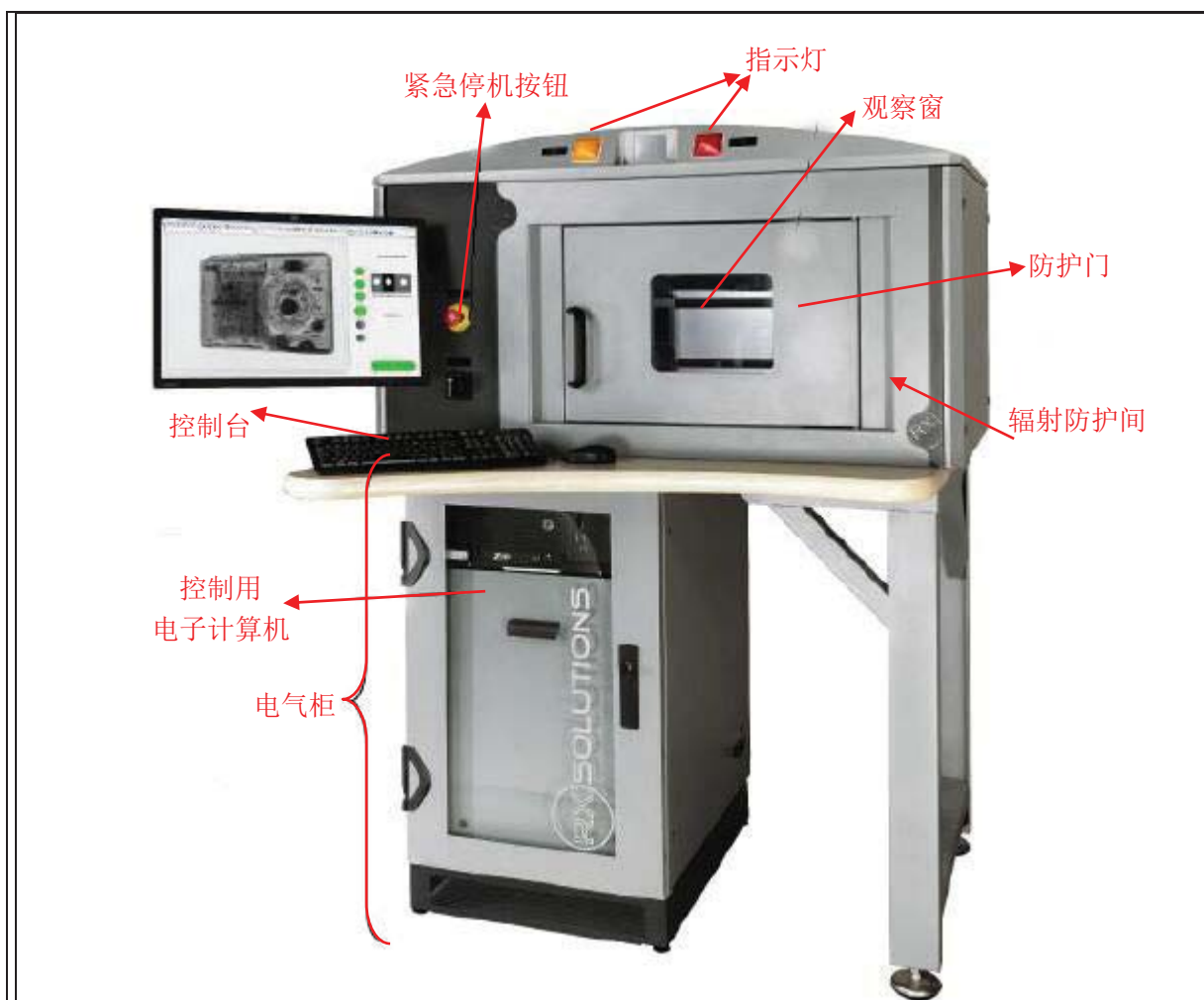
图 7 本项目 Desk-Tom 型 X 射线显微 CT 组成图
