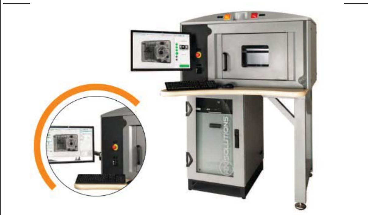
图 6 本项目 Desk-Tom 型 X 射线显微 CT 样图
