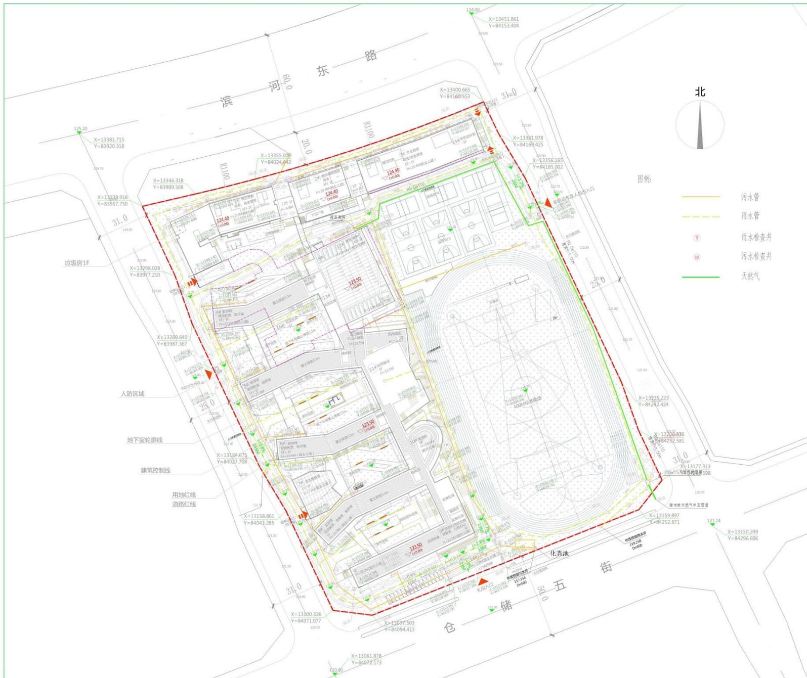
附图 8 项目雨污水管网图
