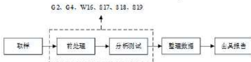
图 13 质检实验工艺及产污节点
