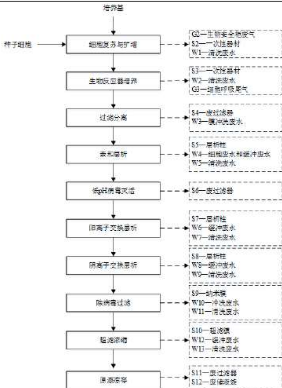
图 11 原液生产流程及产污节点图
