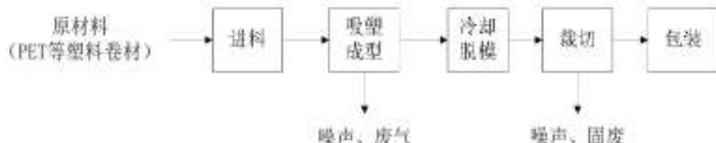
图2 吸塑制品生产工艺流程及产污环节图
