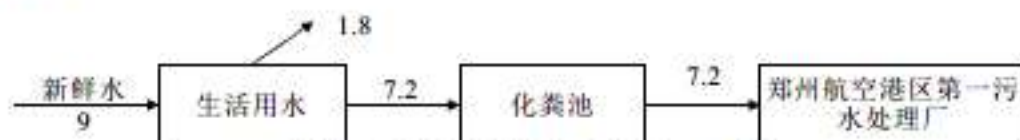
图 1 项目水平衡图（单位 \text{m}^3/\text{d} ）
