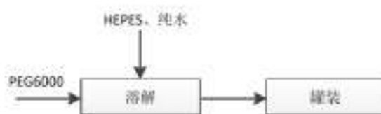
图 2-3 加速剂生产工艺流程及产污环节图
