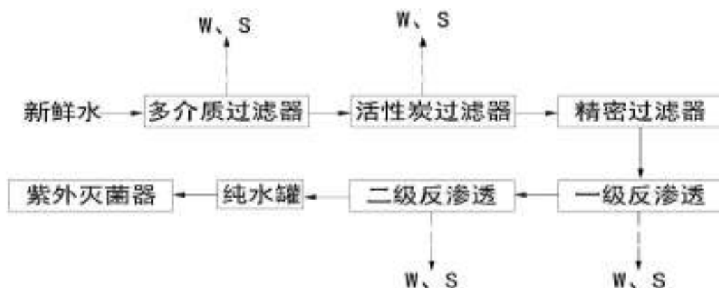
图2-6 纯化水工艺流程图
