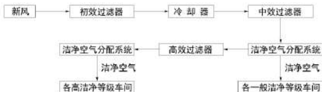
图2-8 GMP车间空气净化系统流程图
