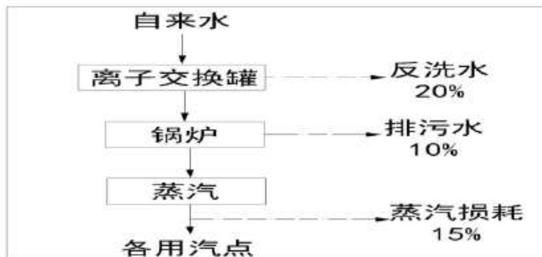
图2-7 软化水工艺流程图
