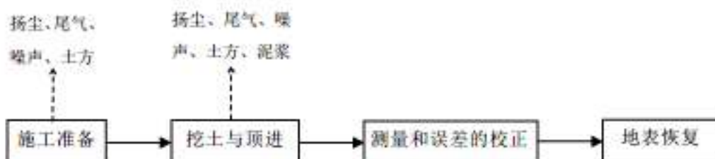
图6 顶管施工工艺及产污环节示意图
