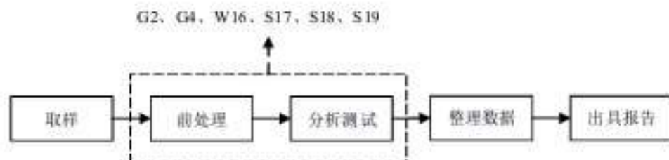
图 3.1-4 质检实验工艺及产污节点
