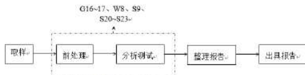
图 3.1-11 质检实验工艺及产污流程图
