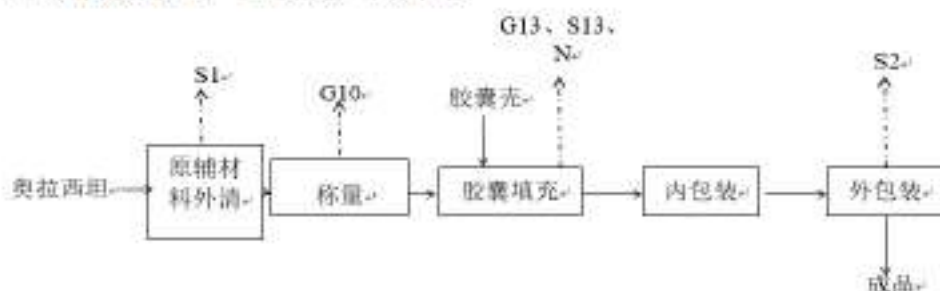
图 3.1-8 胶囊剂生产工艺及产污流程图
