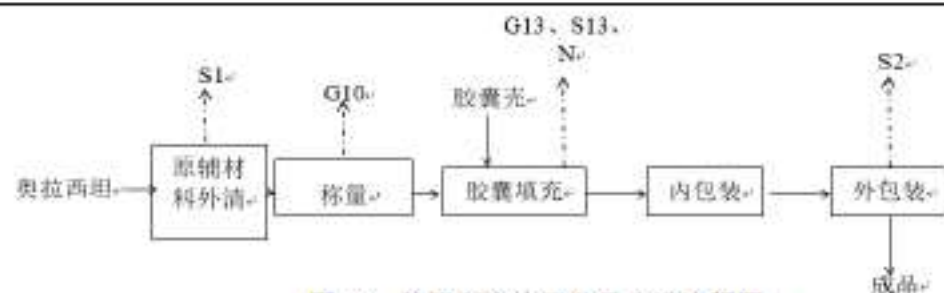
图 12 胶囊剂生产工艺及产污流程图
