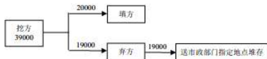
图3 九年制学校土石方平衡图（单位：m 3 ）
