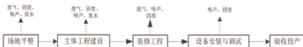
图 1 施工期工艺流程及产污环节示意图
