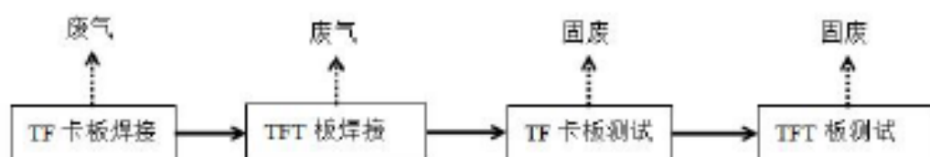
图 5 小板加工工艺流程及产污环节
