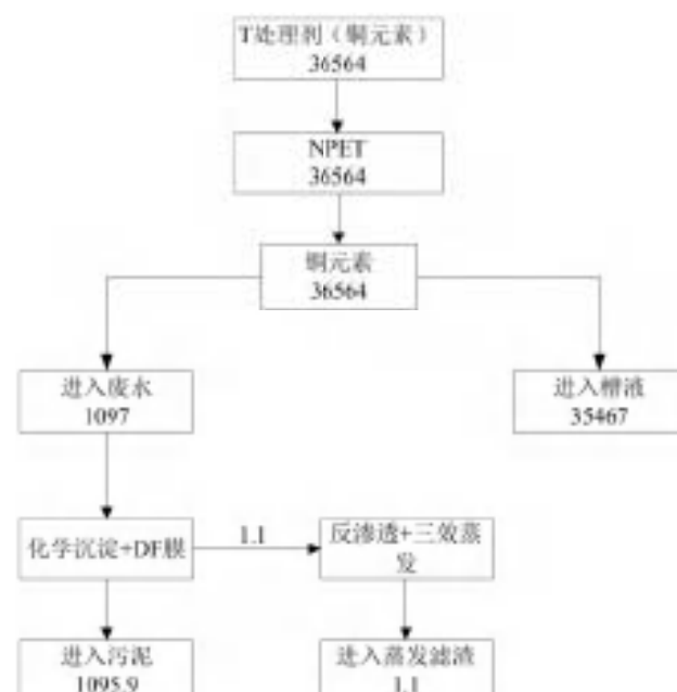
图 2-4 本次工程铜平衡图（单位:kg/a）
