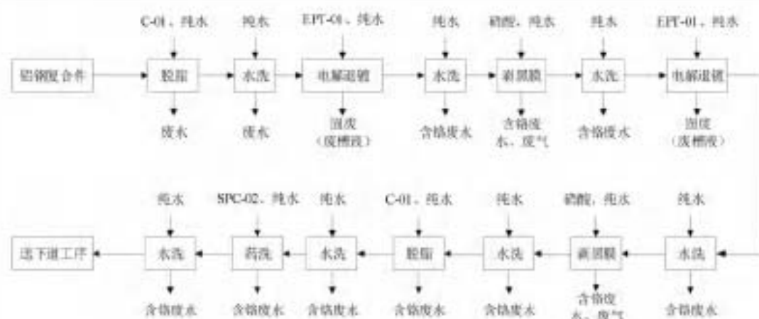
图 2-10 电解退镀工艺流程及产排污环节图
