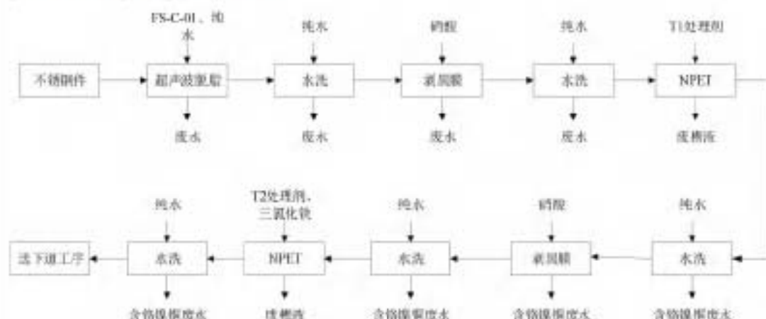
图 2-6 NPET 工艺流程及产排污环节图
