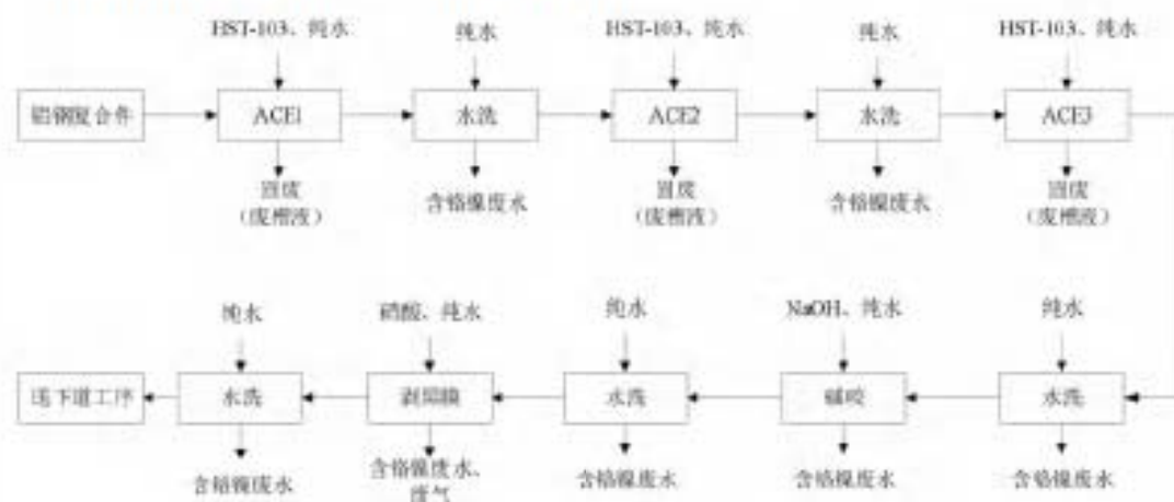
图 2-9 ACE 工艺流程及产排污环节图
