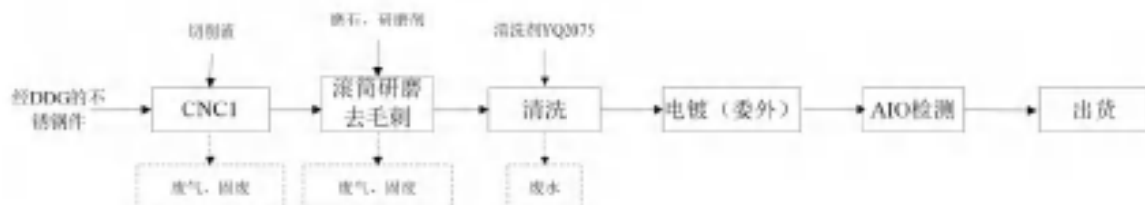
图 2-21 新增耳机小件 H22 铜件工艺流程及产排污环节图
