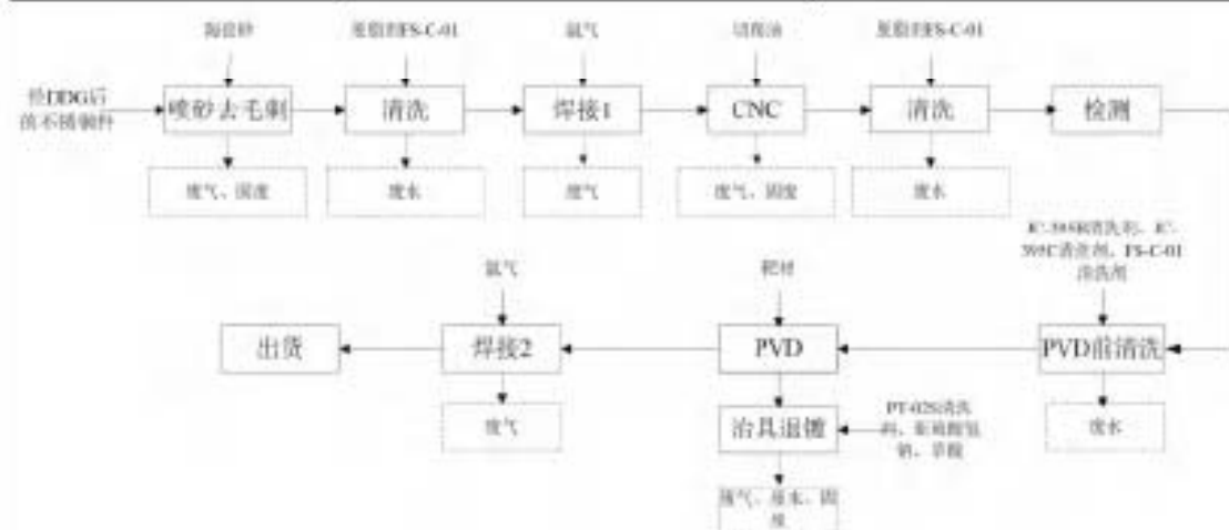
图 2-16 改建后耳机小件的不锈钢件 AH901 工艺流程及产排污环节图
