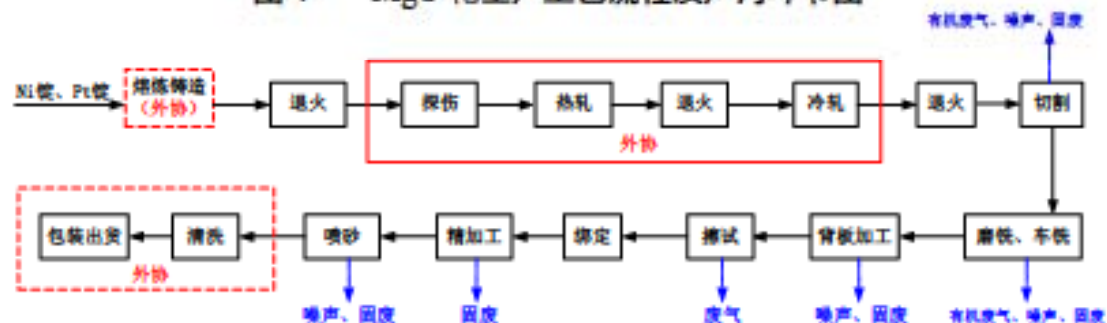
图 5 NiPt 靶生产工艺流程及产污环节图
