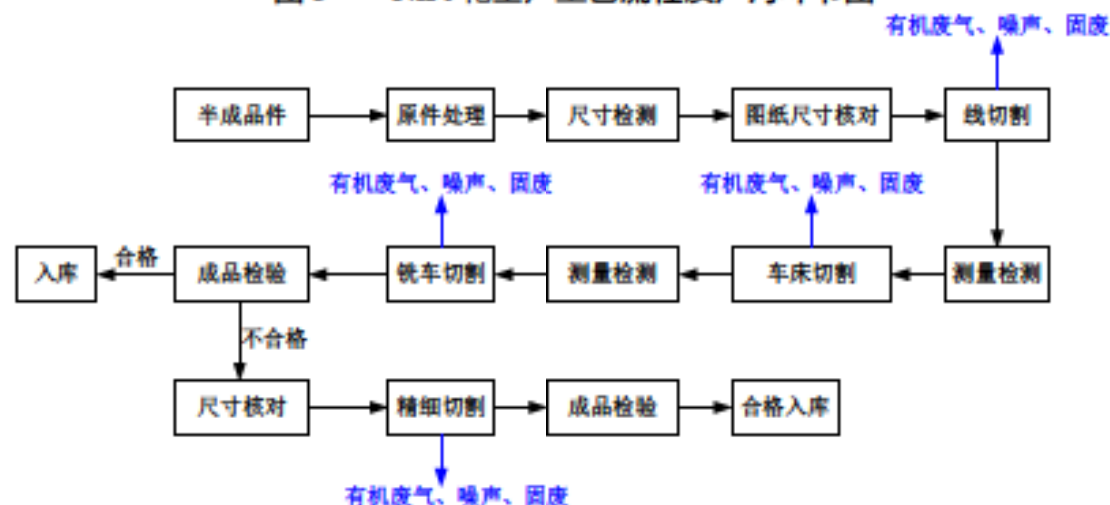
图 6 机械配件生产工艺流程及产污环节图
