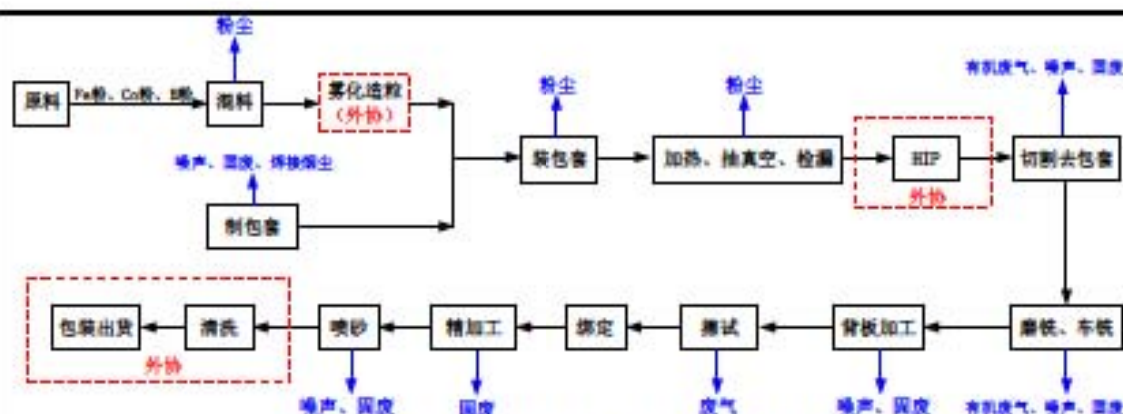
图 3 FeCoB 靶生产工艺流程及产污环节图
