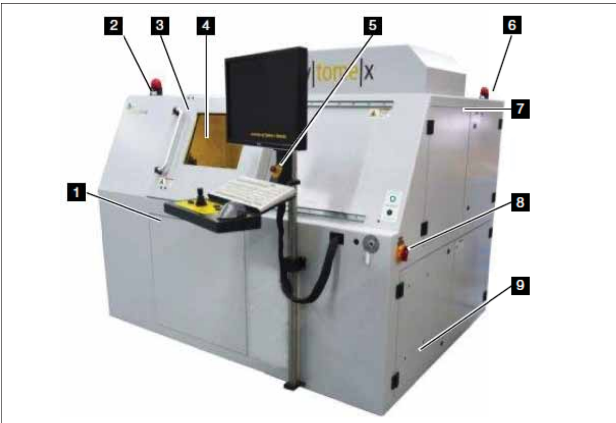
图 8 本项目 v|tome|x S240 型 X 射线计算机断层扫描检测系统组成图
