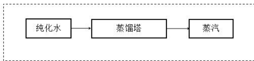
图 2.3-5 纯蒸汽制备工艺流程
