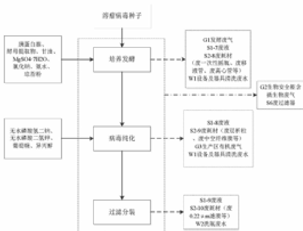
图 3.5-18 溶瘤病毒生产工艺流程图及产污环节
