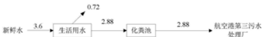
图 11：本项目采暖季（120 天）水平衡图（单位：m 3 /d）
