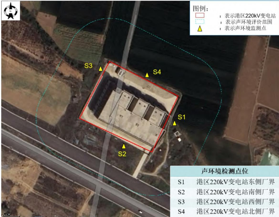
图 8-1 港区 220kV 变电声环境现状监测布点示意图
