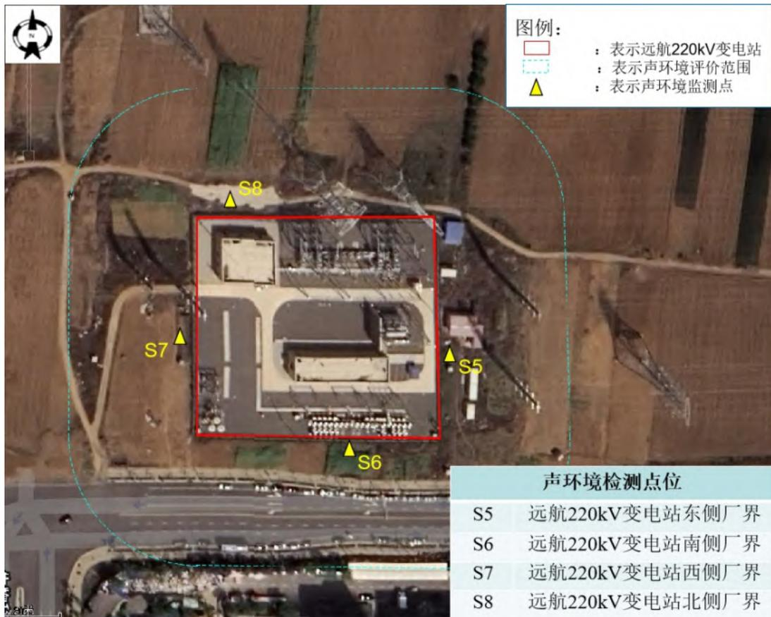
图 8-2 远航 220kV 变电声环境现状监测布点示意图
