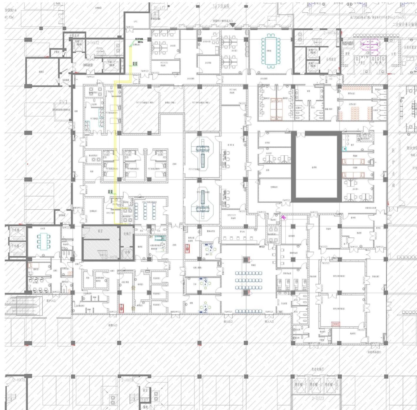
注：潜污泵后管道贴本层梁底设置，接室外相应排水管道；应根据现场实际情况进行调整。
