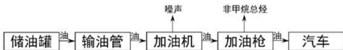
图 2-6 柴油加油工艺流程图
