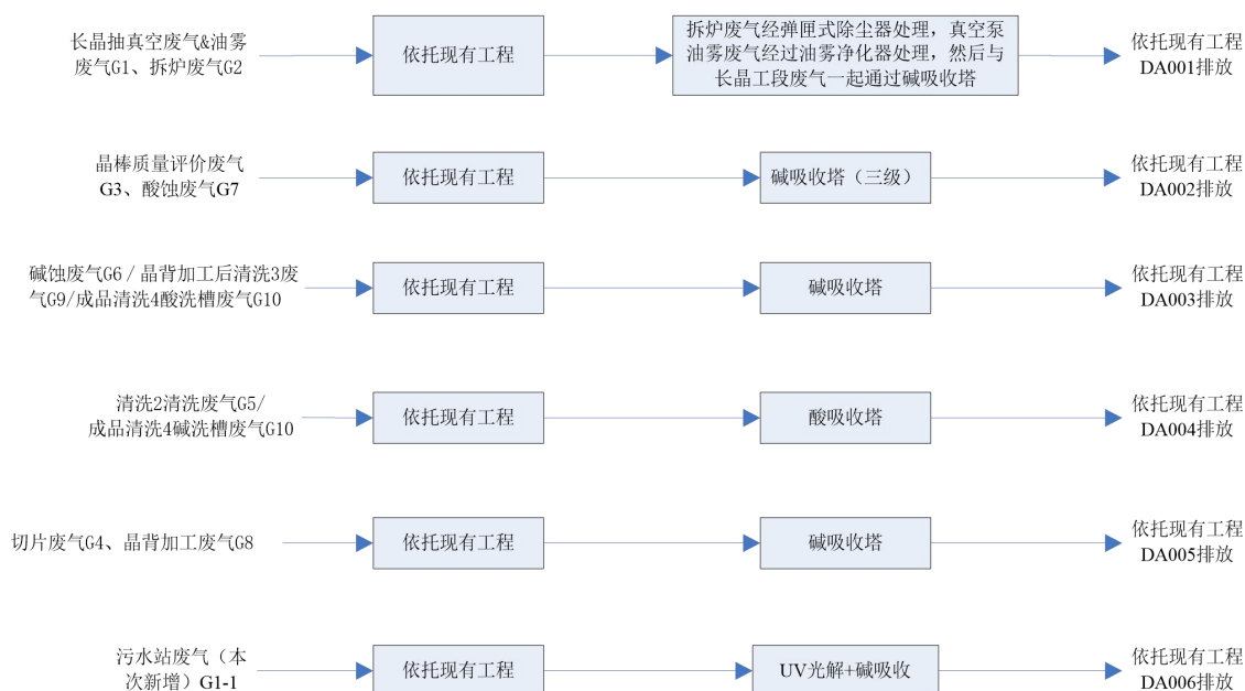
图 5.3-1 本次项目废气治理措施示意图
