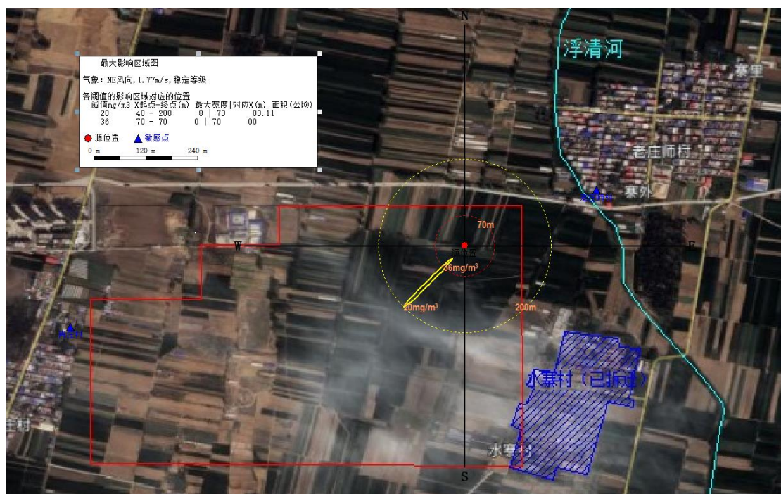
图 5.1-1 最不利气象条件—电解液泄漏 (HF 扩散)
