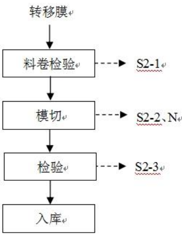
模切工艺流程及产污环节图
