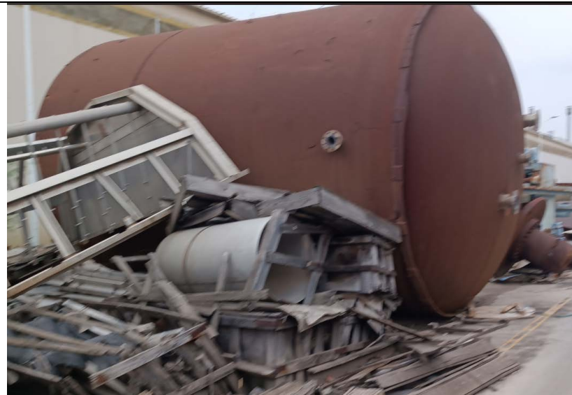
拟利用的污水收集罐
