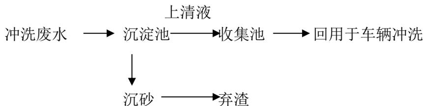
图 6.1-2 运输车辆冲洗废水处理工艺流程图
