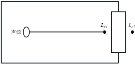
图3. 室内声源等效为室外声源图例
