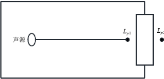
图4. 室内声源等效为室外声源图例
