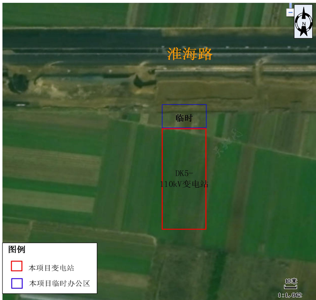
图 2.3 项目施工现场布置图
